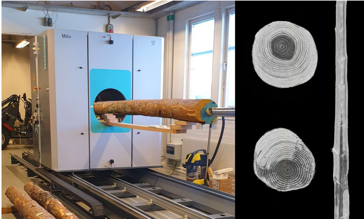
Figur 1. CT-skanning av stockar. Höger: den laboratoriebaseade CT-skannern hos LTU Träteknik i Skellefteå. Höger: Tvärsnitt av skannade stockar, där skada till följd av törskate är mörkare områden utanför kärnveden.
